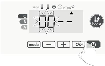
Le code PIN est initialisé, l'appareil vous propose automatiquement le réglage suivant : activation du code PIN.
