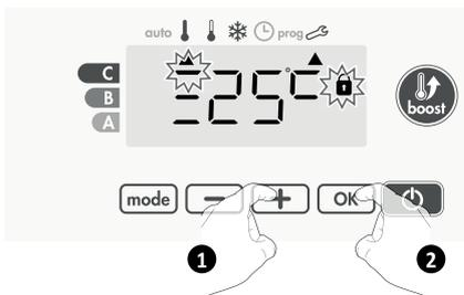
Appuyez sur la touche **OK** pour valider et passer au réglage suivant. Pour sortir des réglages utilisateur, appuyez 2 fois sur **mode**.
