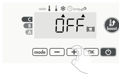
2- Appuyez sur **OK** pour valider et passer au réglage suivant. Pour sortir des réglages installateur, appuyez 3 fois sur **mode**.
