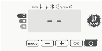
L'appareil s'arrête, -- s'affiche. L'indicateur de mode se positionne sous **auto**. Lorsque l'ordre Confort sera émis, l'appareil sera réactivé jusqu'à la fin du décompte.
