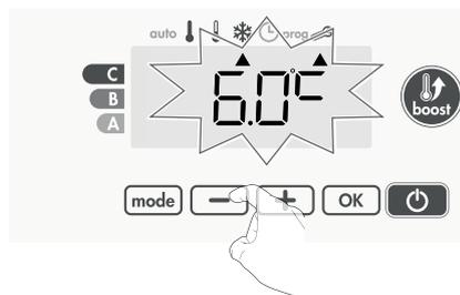
6- Pour valider et passer au réglage suivant, appuyez sur **OK**.
