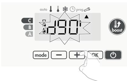
11- Pour valider et passer automatiquement au réglage suivant, appuyez sur **OK**.
