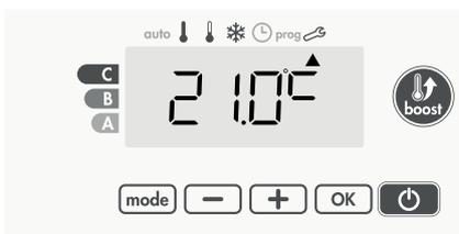
Augmentez de 2°C la température mesurée par la sonde à l'aide de la touche **+**.
