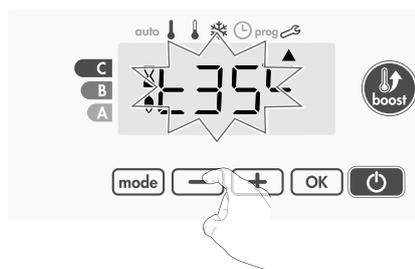
13- Pour valider et passer automatiquement au réglage suivant, appuyez sur **OK**. Pour sortir des réglages utilisateur, appuyez 2 fois sur **mode**.
