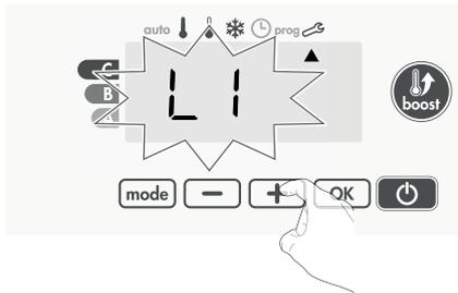
2- Pour valider et passer au réglage suivant, appuyez sur **OK**.
