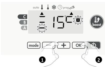
Si vous ne souhaitez pas la modifier, appuyez sur **OK** : l'appareil vous propose automatiquement de régler la butée maximale. Pour sortir des réglages utilisateur, appuyez 2 fois sur **mode**.
