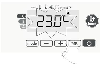
Appuyez sur **OK** pour valider et passer au réglage suivant. Pour sortir des réglages expert, appuyez 3 fois sur **mode**.
